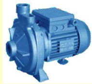
Pompe centrifughe, girante chiusa Corpo pompa e supporto in ghisa girante in ottone
